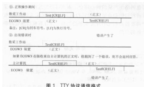
图 1 TTY 协议通信格式
